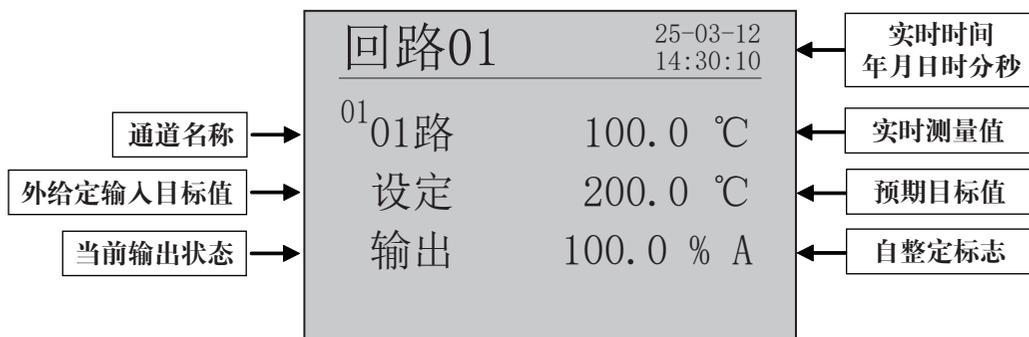
在组态设定参数中“设定类型”修改为CH01~08为外给定控制，此时设定值跟随外部给定信号。
