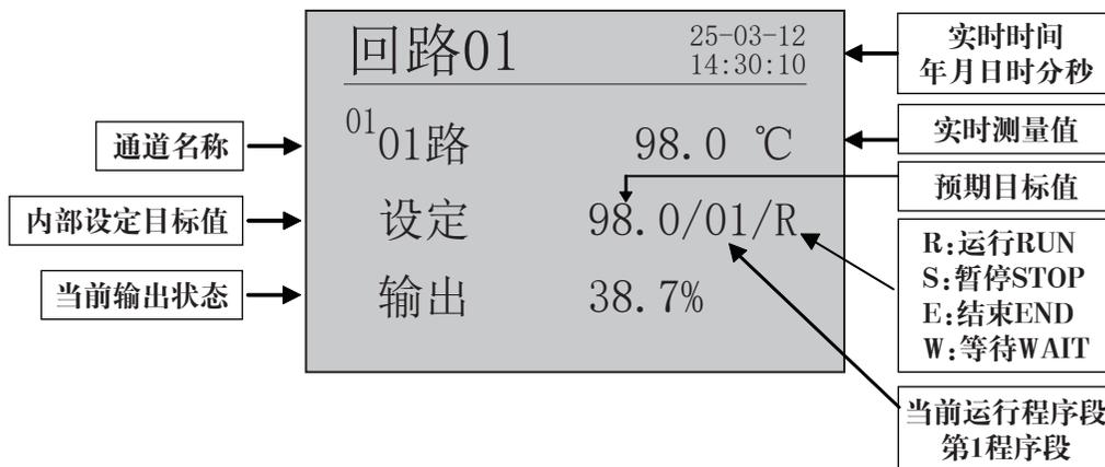
在组态设定参数中“设定类型”修改为PLC为程序段控制。
