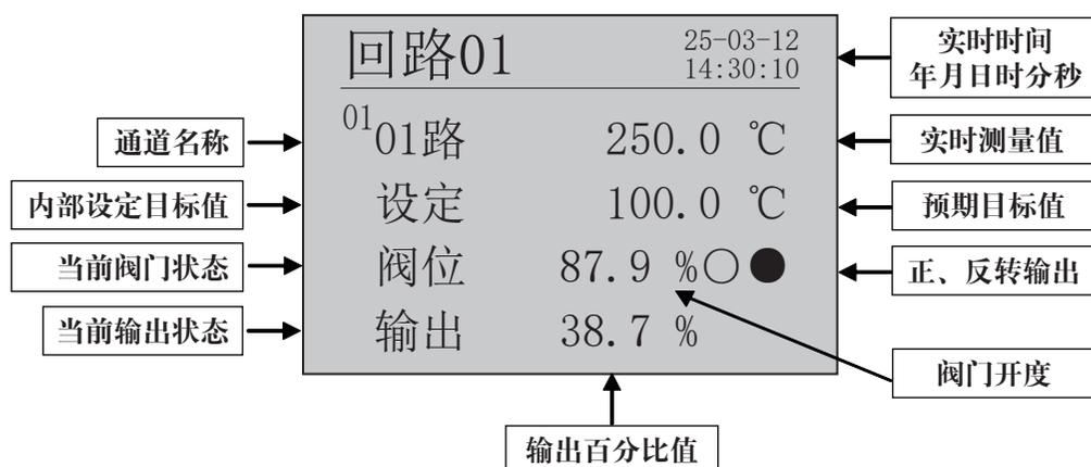
在组态控制参数中“输出类型”修改为FW0/FW1为阀位反馈控制，此时阀位栏的最后两个圆圈表示正、反转标志，左边圆圈表示正转，右边圆圈表示反转。如果处在正转状态，左边圆圈变成实心圆圈；如果处在反转状态，右边圆圈变成实心圆圈。
